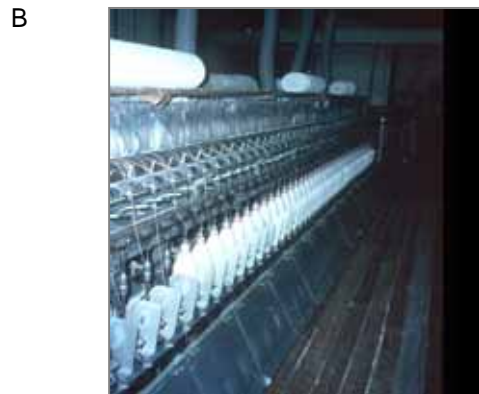
石綿紡績工場。石綿のグレード(品質)の高いもの(長繊維)を開綿・均一にして撚り合わせて糸にします。綿羊(コットン)などと同じ製法です。工場内は相当な粉じんが舞っていたこともありました。
