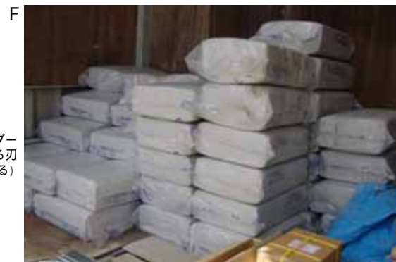
吹きつけ石綿用に工場内で調合された梱包形態(ビニールで圧縮梱包されています)。昔の原綿輸入は麻袋や紙袋に入っており梱包が破れてばく露した、などのケースがありました。
