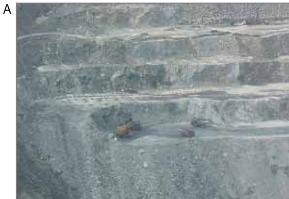
【概要】写真は海外の石綿鉱山(露天掘り)です。地下掘りの鉱山もあります。我が国の石綿鉱山は昭和20年代までに多くが閉山し、現在、石綿鉱山はありません。また蛇紋岩系の採掘場では不純物として白石綿が混入している可能性があります。
