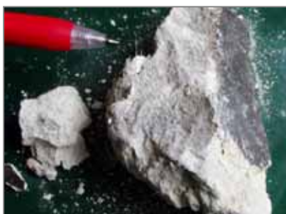
煙突材(茶石綿)
