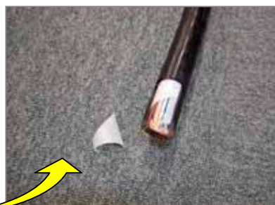
ケーブル内絶縁用紙(電気絶縁)として使用
