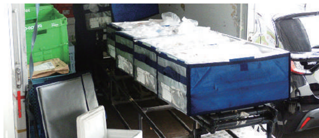
可動式のローラーコンベアで荷物を積み込む
