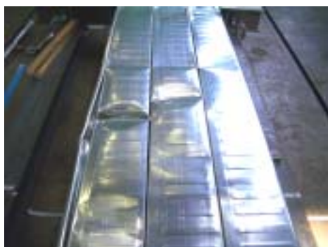
(a) 中央部で変形 (固定, 閉塞型デッキ A, 厚さ 0.8mm)
